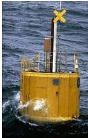
Σχήμα 2.7: Σύστημα Ενέργειας Κυμάτων (AquaBuOY)
