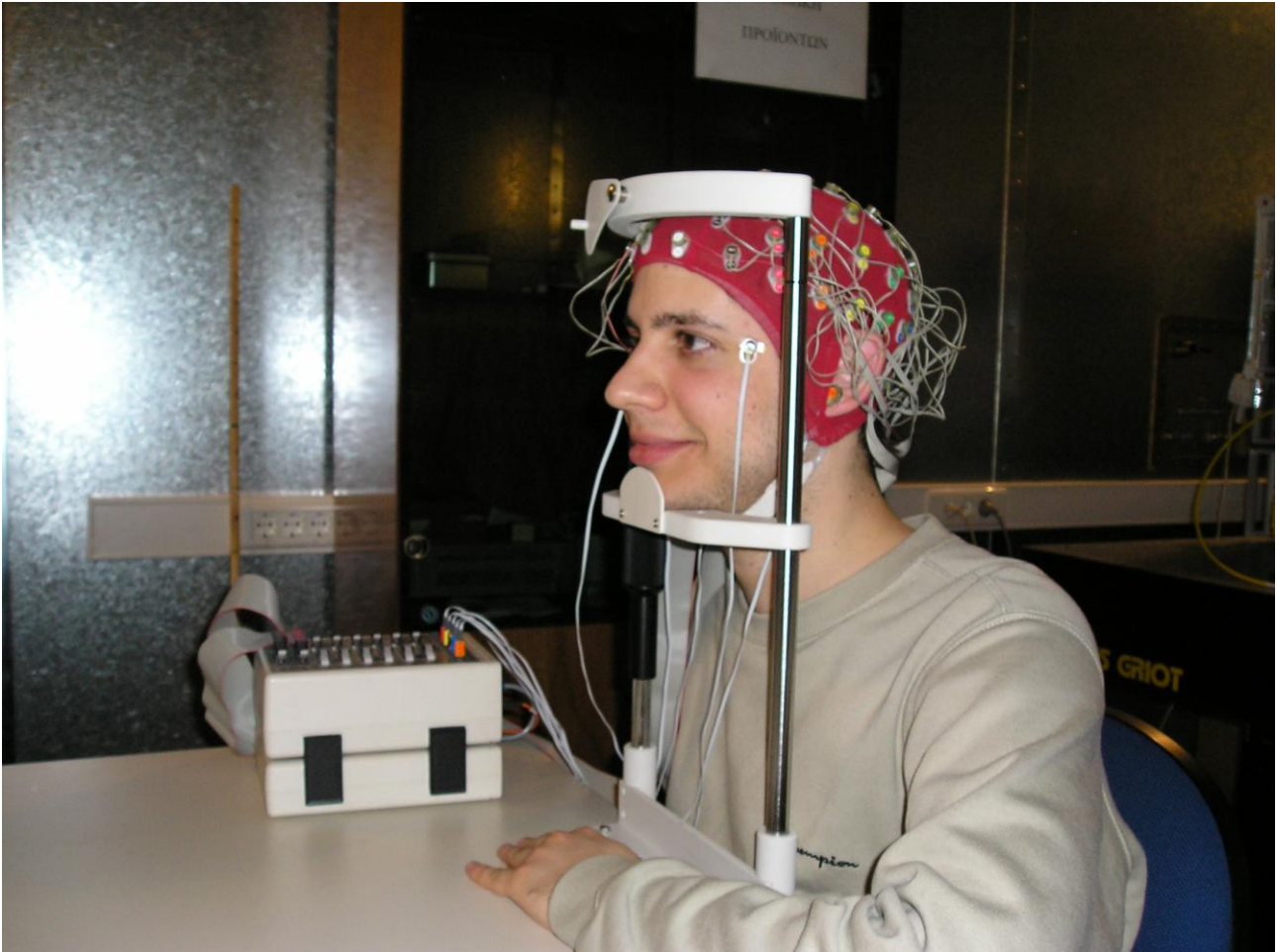
Σχήμα 6.1 Στιγμιότυπο εξεταζόμενου ατόμου με τα 64 ηλεκτρόδια λήψης του εγκεφαλογραφήματος και τα εξωτερικά λήψης οφθαλμογραφήματος. Το κεφάλι του είναι τοποθετημένο σε ειδικό στήριγμα.
