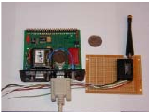
Εικόνα 3 Σύστημα εντοπισμού που αναπτύχθηκε στο Berkeley
