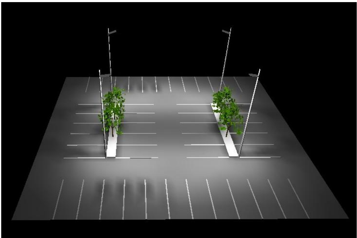
Εικόνα 7-20: Τρισδιάστατη απεικόνιση του χώρου με τα φωτιστικά υπό λειτουργία (3D luminance)
