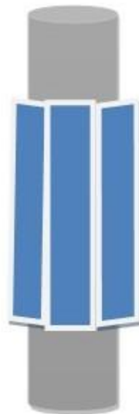
Εικόνα 6-4: Σχέδιο ιστού φωτισμού με 3 φ/β στοιχεία
