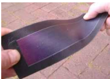
Εικόνα 2-2: Thin film άμορφου πυριτίου (a-Si)
