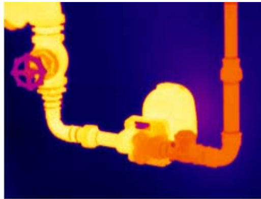
Εικόνα 3.4.4: Θερμογραφήματα λέβητα και σωληνώσεων
