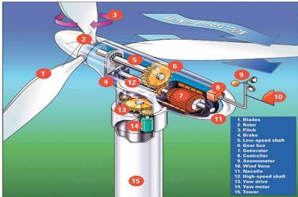
Σχ. 3.7 Βασικά μέρη ανεμογεννήτριας.
