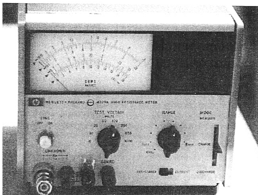
Σχήμα 1.1 : Πρόσμη αναλογικής συσκευής HP 4329A του οίκου Hewlett-Packard μέσω της οποίας γίνονται οι μετρήσεις της ωμικής αντίστασης των αντιστατικών δαπέδων, με την διαδικασία που περιγράφεται στους κανονισμούς DIN 51953 και DIN 53482.
