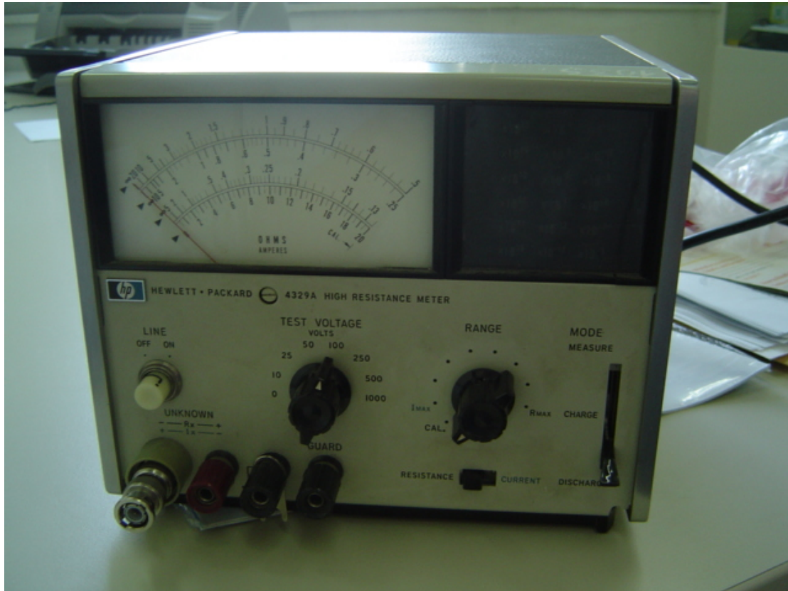
Σχήμα 1.2 : Φωτογραφία αναλογικής συσκευής HP 4329A του οίκου Hewlett-Packard μέσω της οποίας γίνονται οι μετρήσεις της ωμικής αντίστασης των αντιστατικών δαπέδων, με την διαδικασία που περιγράφεται στους κανονισμούς DIN 51953 και DIN 53482.
