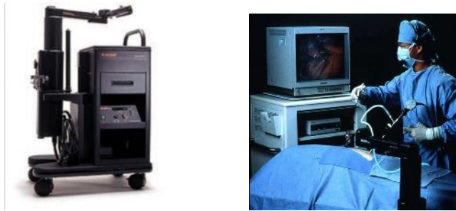
Εικ. 3.9: Το σύστημα AESOP (αριστερά) και χειρουργική επέμβαση με αυτό (δεξιά)
