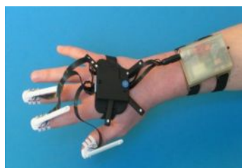
Εικ. 5.12: Πειραματικές διατάξεις για ανάδραση αφής στα δάχτυλα του χεριού (αριστερά) και σε χειρουργικό εργαλείο (δεξιά)
