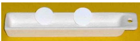
Σχήμα Β.1: Πυρίμαχο σκαφίδι και δισκία προς θερμική κατεργασία
