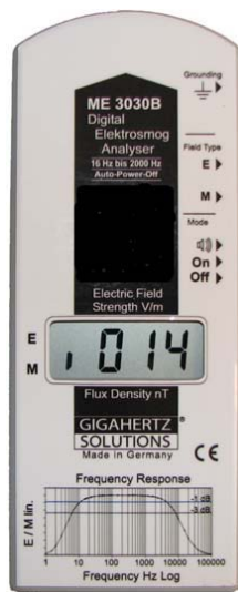
Σχήμα B.5: Πεδιόμετρο ME 3030B της GIGAHERTZ SOLUTIONS.
