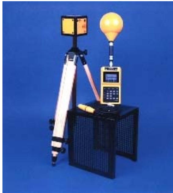
Σχήμα Β.11: Όργανο μέτρησης EFA-300 με ανιχνευτές ηλεκτρικού και μαγνητικού πεδίου
