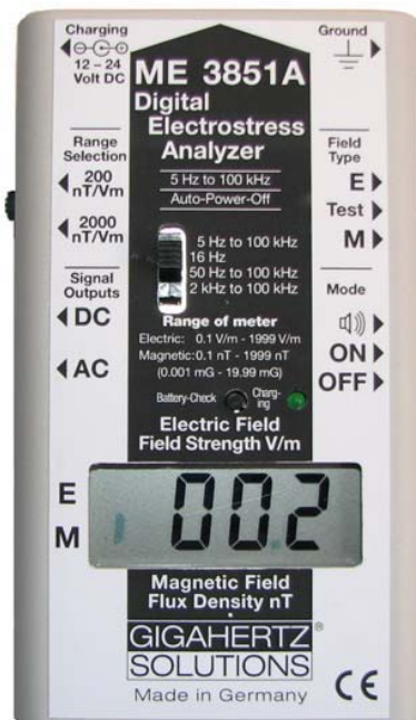
Σχήμα Β.6: Πεδίομετρο ME 3851A της GIGAHERTZ SOLUTIONS.
