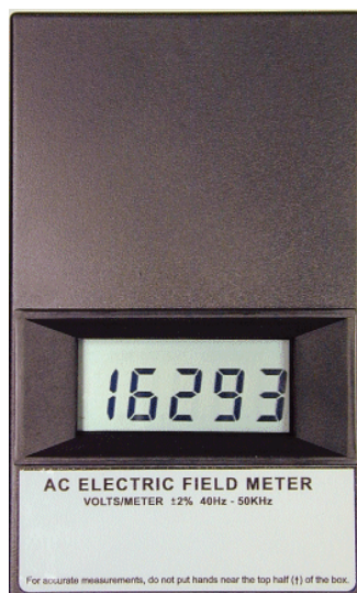
Σχήμα Β.1: Πεδιόμετρο Digital AC Electric Field Meter της AlphaLab, Inc.
