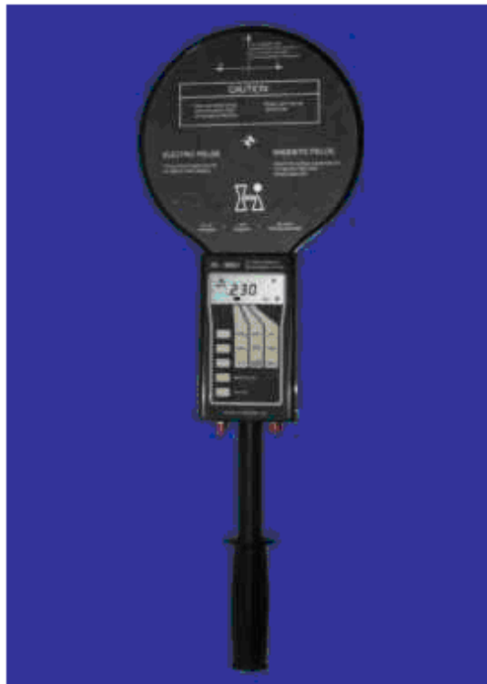
Σχήμα Β.4: Πεδίομετρο HI-3604 ELF Survey της ETS-LINDGREN.
