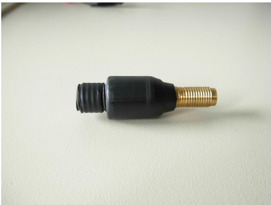
Εικόνα 3.1.7: δοκίμιο στερεωμένο στην ειδική υποδοχή που εφαρμόζει στον άξονα του ρότορα
