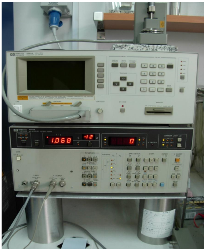
Εικόνα 3.3.3 : εφαρμογή τάσης dc - πικοαμπερόμετρο (κάτω)
