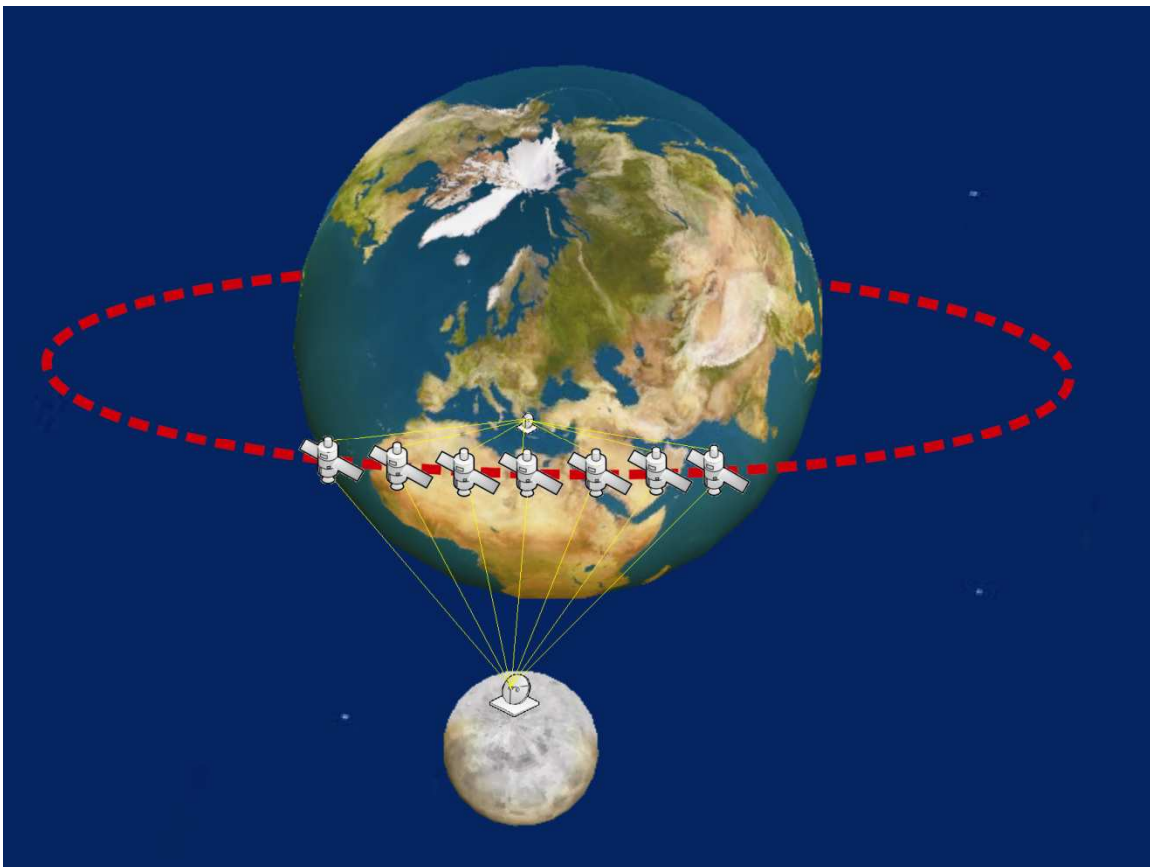
Σχήμα 2-4: Τοπολογία διαπλανητικού δικτύου και πιθανές διαδρομές των δεδομένων.
