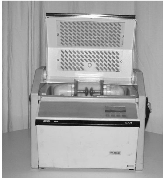
Σχήμα 9.1: Συσκευή εκτέλεσης δοκιμών BAUR DPA 75 Insulating Oil Tester 75 kV.
