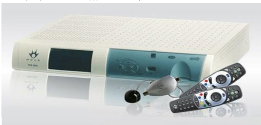
Σχήμα 10 :Ο Panasat PVR 3001 με δύο τηλεχειριστήρια για θέαση σε δύο τηλεοράσεις με μια συνδρομή
