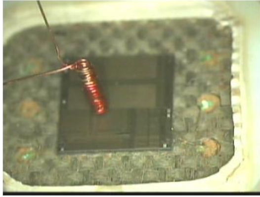
Σχήμα 11: Παρατήρηση ηλεκτρομαγνητικών αποκρίσεων της έξυπνης κάρτας σε επιλεγμένες εισόδους
