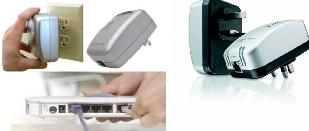
Σχήμα 7: Αποστολή control words μέσω ανταπτόρων και δικτύου ηλεκτρικού ρεύματος
