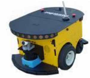
Εικόνα 1.5: Αυτόνομο έντροχο ρομπότ με αισθητήρα laser.
