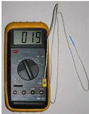
Σχήμα 1.2-1: Θερμοστοιχείο συνδεδεμένο σε πολύμετρο
