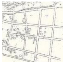
Σχήμα 3.6 Ορθογωνική μορφή δικτύου
