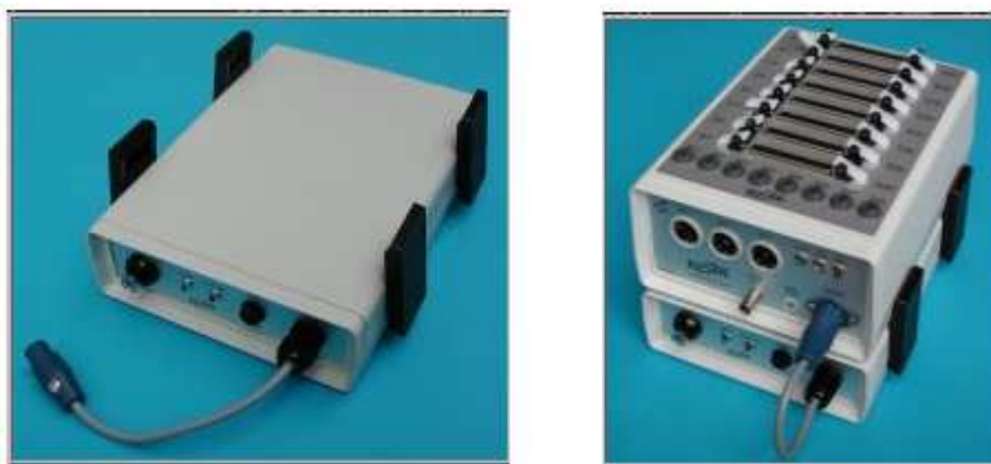
Σχήμα 3.8: Κουτί μπαταρίας και ενισχυτής συνδεδεμένος στο κουτί μπαταρίας.
