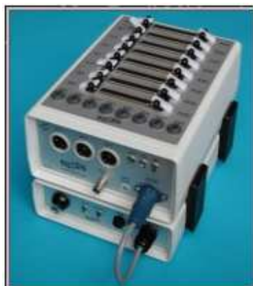
Σχήμα 3.6: αριστερά: κουτί AD 256 καναλιών με μπαταρία, δεξιά: κύκλωμα ενισχυτή / μετατροπέα 8 καναλιών
