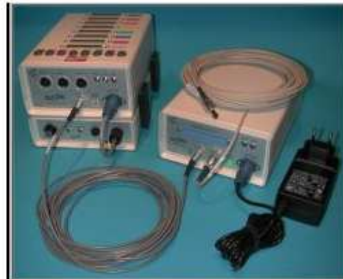
Σχήμα 3.10: αριστερά: κουτί αναλογικής εισόδου, δεξιά: κουτί AD συνδεδεμένο μέσω οπτικής ίνας σε κουτί αναλογικής εισόδου.
