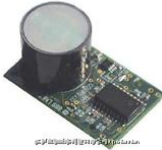
Σχήμα 4.2 Αισθητήρες υπερύθρου για την ανίχνευση CO 2 [36]
