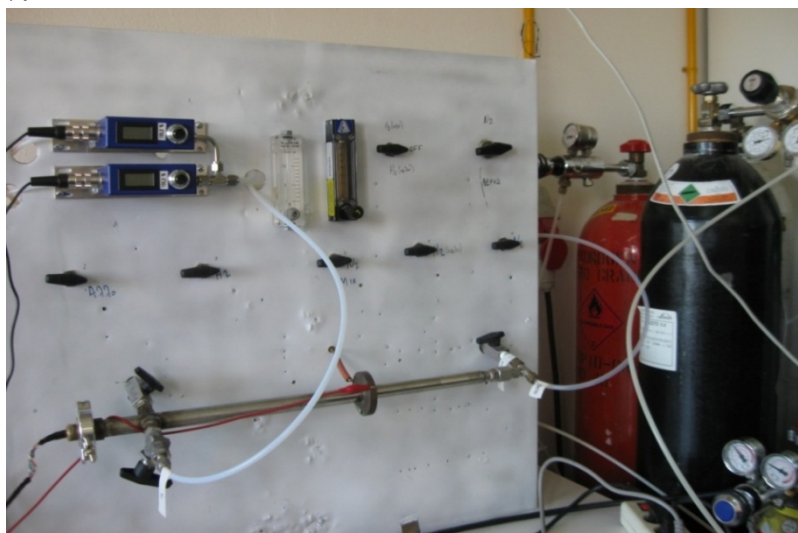
Σχήμα 6.1 Φωτογραφία πειραματικής διάταξης για την μέτρηση της απόκρισης των υμενίων παρουσία των αερίων
