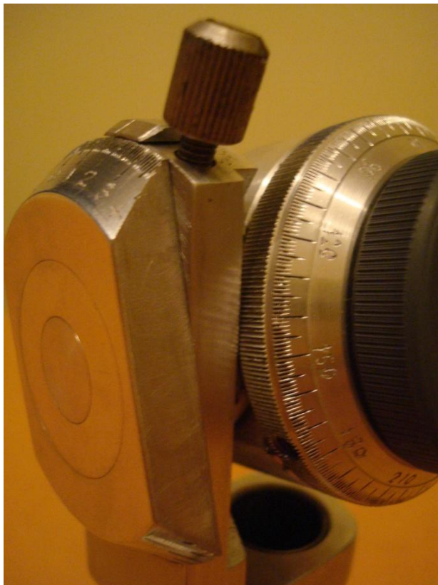
Σχήμα 4.5 Ρύθμιση γωνίας ανύψωσης και περιστροφής ήλου ως προς τον άξονά του
