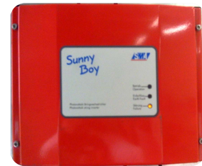
Εικόνα 8.6 : Αντιστροφέας DC/AC σύνδεσης φ/β
