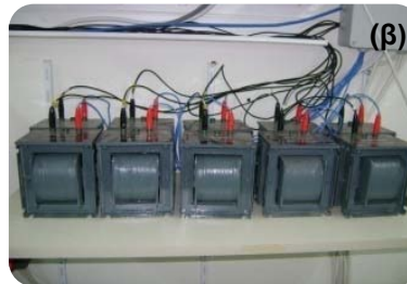
Εικόνα 8.9: Φορτία προσομοίωσης προφίλ καταναλώσεων (α) μονοφασικός κινητήρας, λάμπες φθορισμού/πυρακτώσεως και 2 ρευματοδότες (β) πηνία
