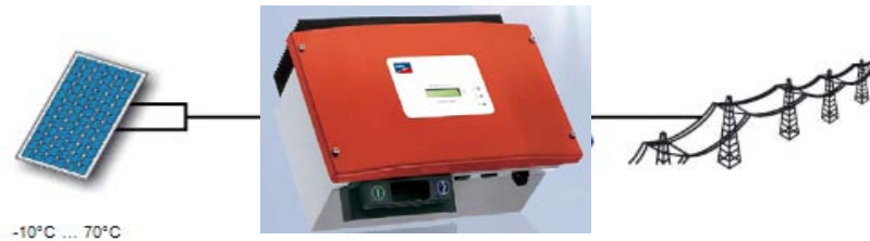
Σχήμα Α.8: Προτεινόμενος αντιστροφέας για το διασυνδεδεμένο φ/β σύστημα της Ραφήνας
