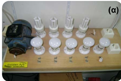
Εικόνα 8.9: Φορτία προσομοίωσης προφίλ καταναλώσεων (α) μονοφασικός κινητήρας, λάμπες φθορισμού/πυρακτώσεως και 2 ρευματοδότες (β) πηνία
