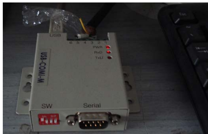
Σχήμα Α.7: Εξωτερικός μετατροπέας RS232-USB/RS485
