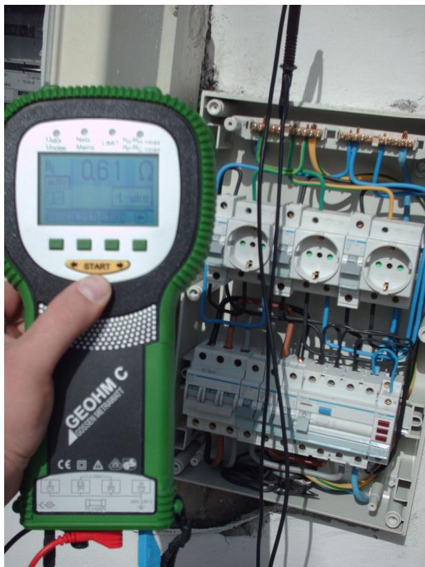
**Εικόνα 3.3-1:** Λήψη μέτρησης της αντίστασης γείωσης R<sub>E</sub>
