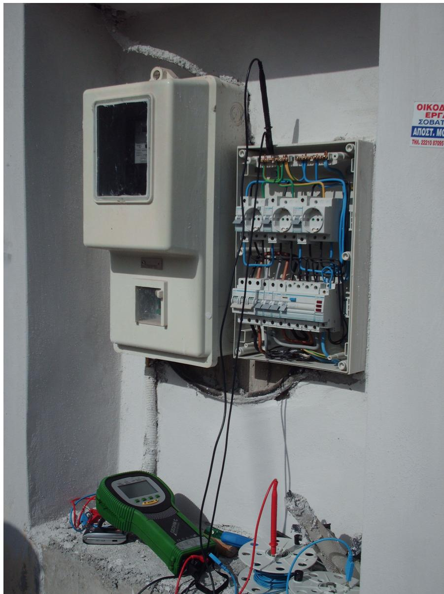
**Εικόνα 2.3-3:** Σύνδεση του οργάνου με τον κόμβο των γειώσεων για την τετραπολική μέτρηση του συστήματος γείωσης.
