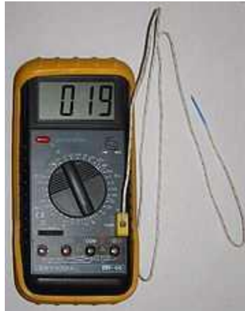
Σχήμα 1.2.1.1: Θερμοστοιχείο συνδεδεμένο σε πολύμετρο
