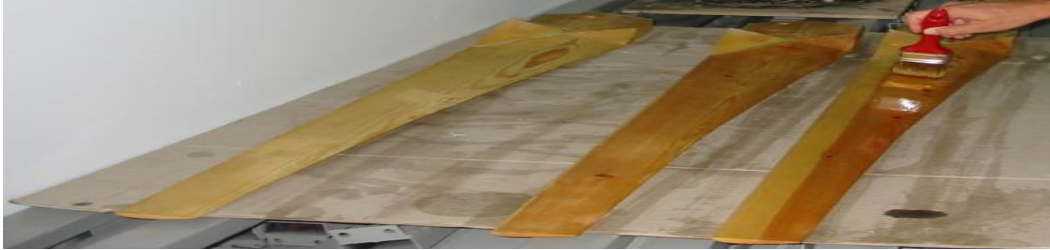
Σχήμα 2.6: Εμποτισμός των πτερυγίων με βερνίκι.
