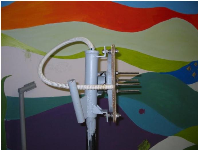
Σχήμα 5.7: Συναρμολόγηση της γεννήτριας.
