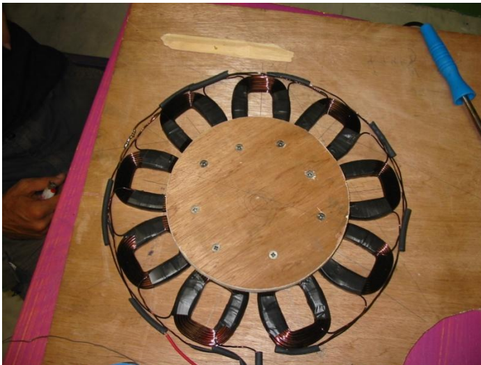
Σχήμα 5.3: Σταθεροποίηση των πηνίων στις επιθυμητές θέσεις και πραγματοποίηση της συνδεσμολογίας.
