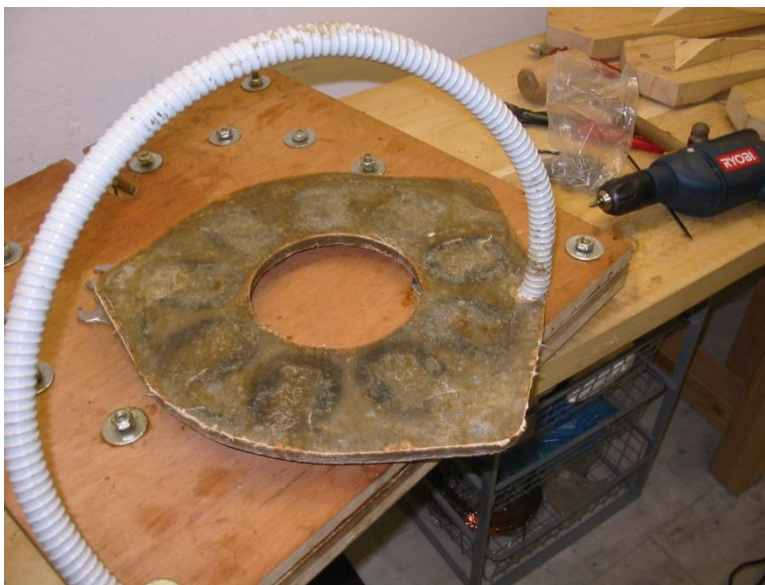
Σχήμα 5.4: (α) Η πλάκα του στάτη μέσα στο καλούπι μετά την στερεοποίηση της ρητίνης. (β) Η πλάκα του στάτη έτοιμη για τοποθέτηση.
