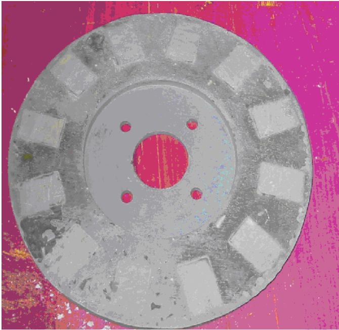
Σχήμα 5.5: Ο ένας δίσκος του δρομέα έτοιμος για τοποθέτηση.
