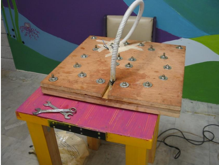
Σχήμα 5.2: Καλούπι κατασκευής του στάτη.
