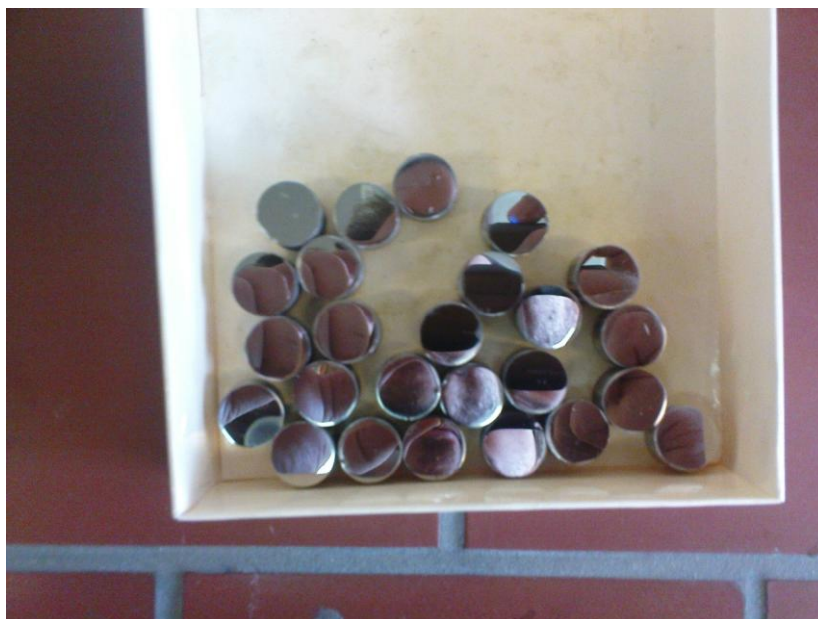
Σχήμα 6-10 Τελική εικόνα δοκιμών, μετά τη λείανση, έχοντας αποκτήσει mirror finish
