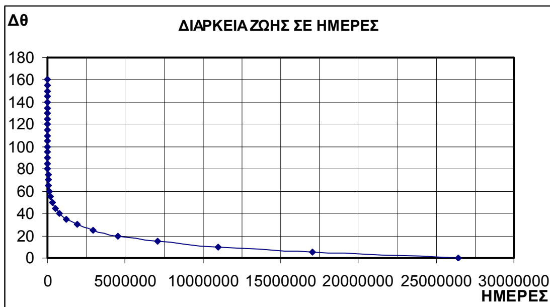
Σχήμα 2.6 Διάρκεια ζωής στερεών μονωτικών σε μέρες, σε σχέση με την θερμοκρασία
