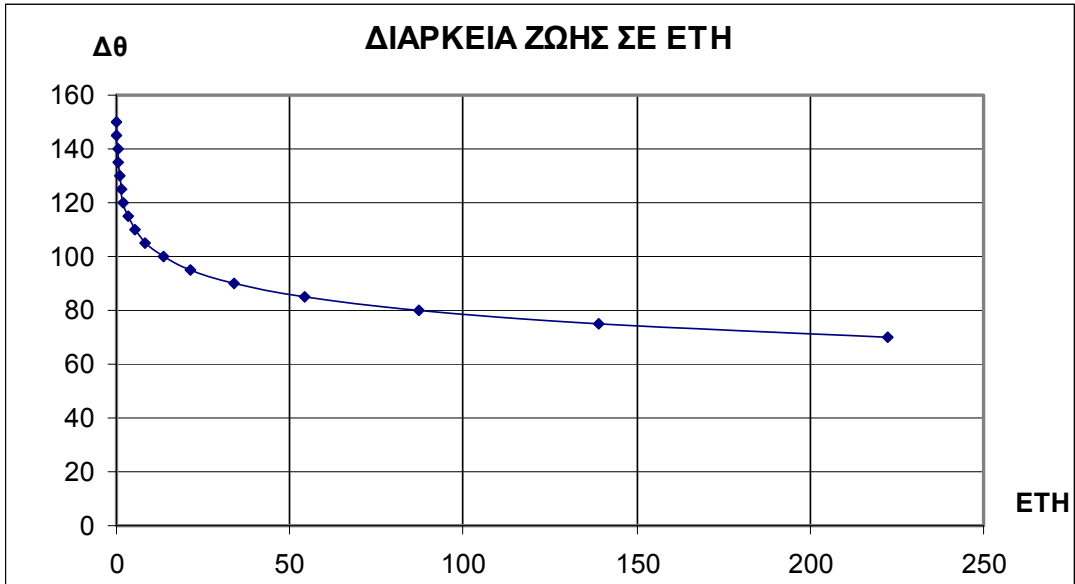
Σχήμα 2.4 Διάρκεια ζωής στερεών μονωτικών σε έτη, σε σχέση με την θερμοκρασία
