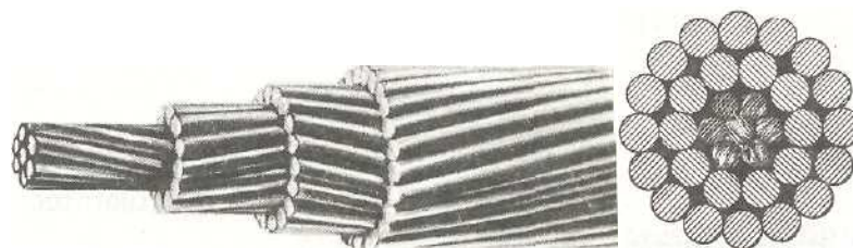
Σχήμα 1.3 Διατομή αγωγού αλουμινίου-χάλυβα. (ACSR).
