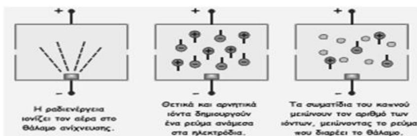
Εικόνα 2.3.2.2-1 Αρχή λειτουργίας ανιχνευτή ιονισμού.
