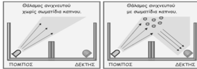
Εικόνα 2.3.2.2-2 Αρχή λειτουργίας ανιχνευτή ορατού καπνού.
