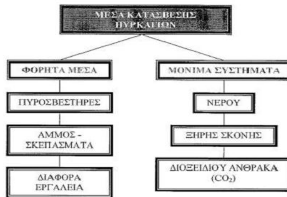
Εικόνα 1.6.2.2-2 Διαχωρισμός μέσων κατάσβεσης πυρκαγιών.
