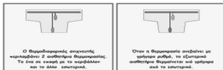
Εικόνα 2.3.2.1-1 Αρχή λειτουργίας θερμοδιαφορικού ανιχνευτή.
