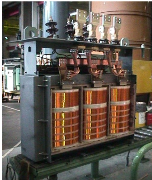
Σχήμα 4.5: Μετασχηματιστής άμορφου πυρήνα από μέσα [13]
