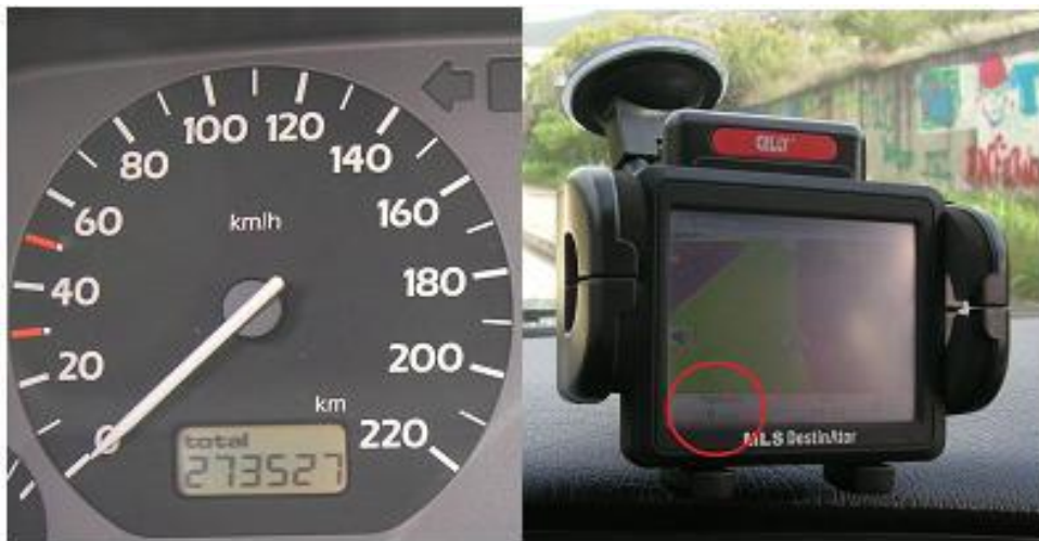
Εικόνα 7.17: Έλεγχος ταχύτητας αυτοκινήτου με αναλογικό ταχύμετρο και δέκτη GPS
