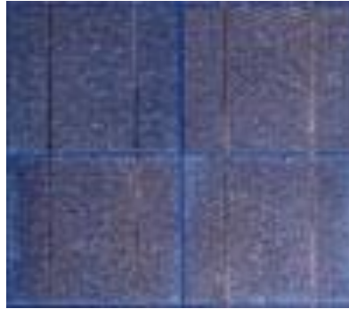
ΕΙΚΟΝΑ 13. ΦΩΤΟΒΟΛΤΑΪΚΟ ΣΤΟΙΧΕΙΟ ΤΑΙΝΙΑΣ ΠΥΡΙΤΙΟΥ
