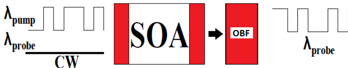
Εικ.24 Μετατροπές μήκους κύματος που βασίζεται στο φαινόμενο XGM, κάνοντας χρήση ενός SOA και ενός οπτικού βαθυπερατού φίλτρου (OBF). Παρατηρούμε την αντεστραμμένη πολικότητα του σήματος εξόδου σε σχέση με το σήμα εισόδου.
