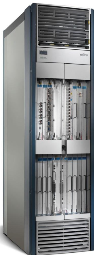
Εικ.10 Δρομολογητής CRS1 της CISCO. Ζυγίζει 723kg, έχει ύψος 2,13m και καταναλώνει 10kW.
