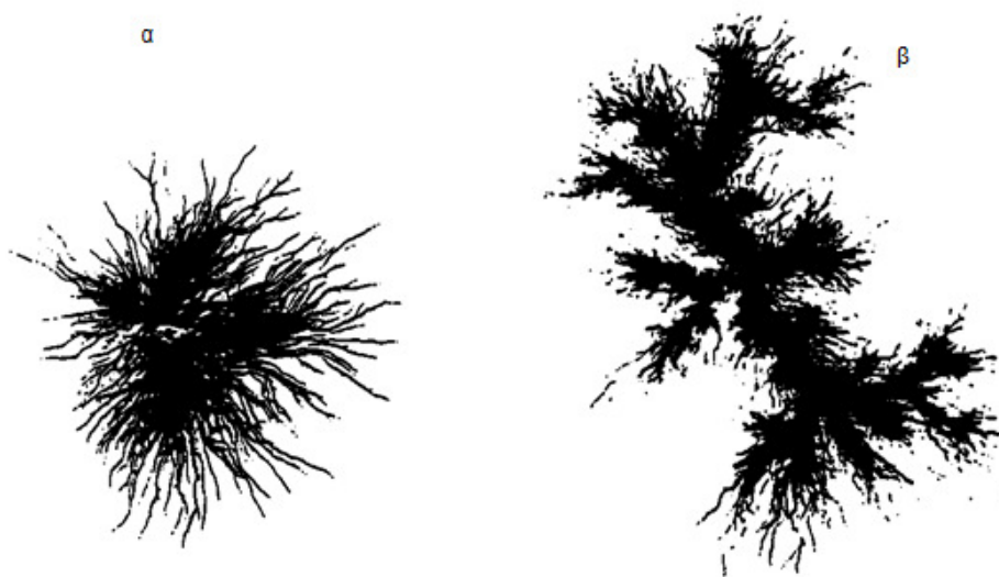
Σχήμα 1.4.3.4-4: Φωτογραφίες δενδριτών κατά την καταπόνηση πολυμερών στερεών μονωτικών στον αέρα, υπό κρουστική τάση 1,2/50μs (διάταξη ηλεκτροδίων: ακίδα-πλάκα).
