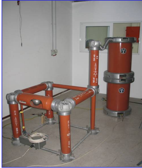
Σχήμα 3.2 Ανόμενη μονοβάθμια κρουστική γεννήτρια
