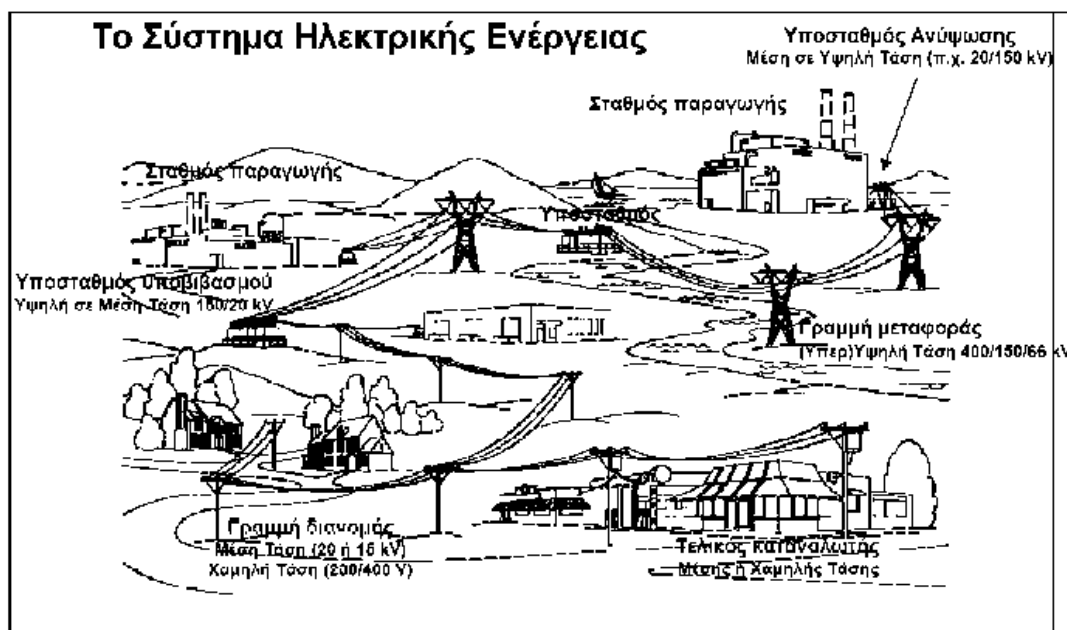
Σχήμα 1.1-1 : Σύστημα Ηλεκτρικής Ενέργειας
