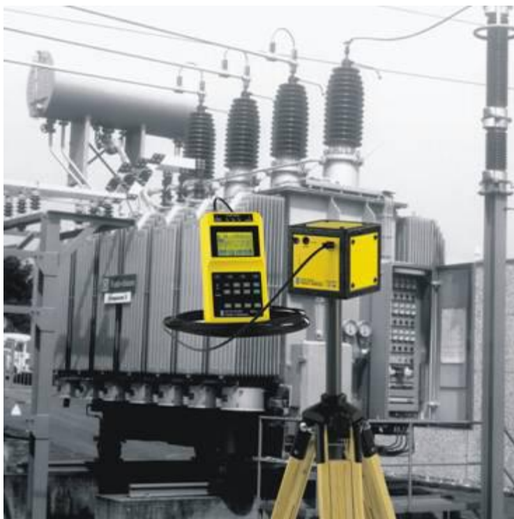
Σχήμα Α.3: Χρήση πεδιομέτρου και αισθητήρα EFA 300 για μετρήσεις ηλεκτρικού πεδίου
