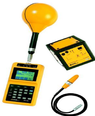
Σχήμα Α.1: Το πεδιόμετρο, οι αισθητήρες και η οπτική ίνα που χρησιμοποιήθηκαν για την διεξαγωγή των μετρήσεων
