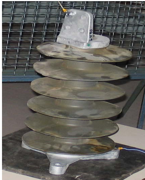
Σχήμα 4.2: Το καθοδικό αλεξικέραυνο που χρησιμοποιήθηκε για την διεξαγωγή των πειραματικών μετρήσεων
