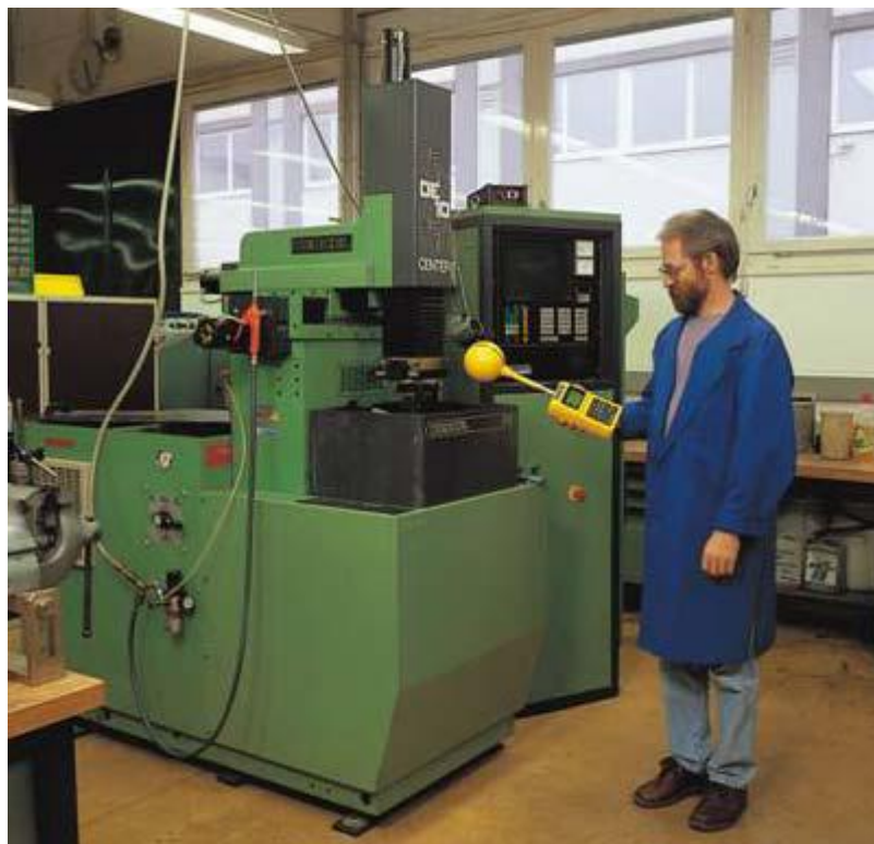
Σχήμα Α.2: Χρήση πεδιομέτρου και αισθητήρα EFA 200 για μετρήσεις μαγνητικού πεδίου
