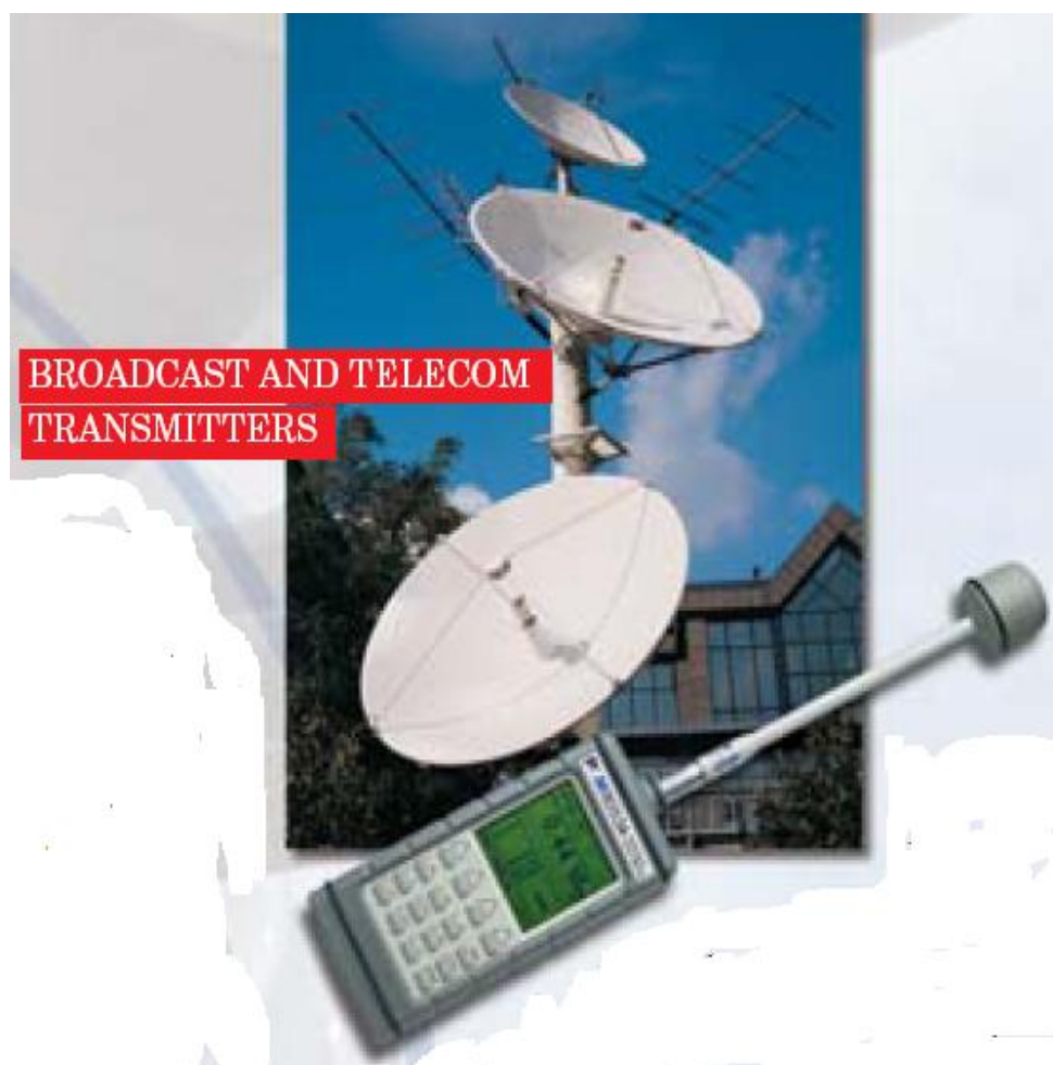
Σχήμα Α.7: Μέτρηση ηλεκτρικού και μαγνητικού πεδίου σε τηλεπικοινωνιακά δίκτυα
