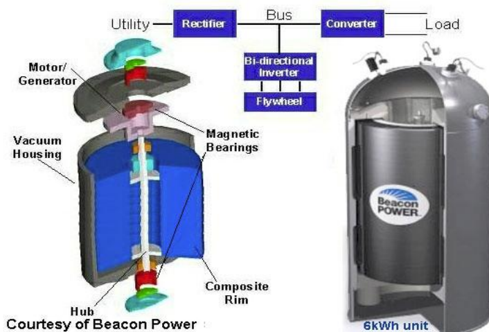
Σχήμα 2.4: Τυπική διάταξη μιας μονάδας flywheel
