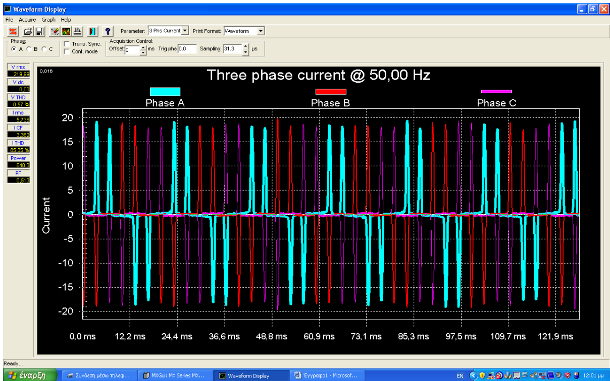
Σχήμα 5.21 – Τριφασικό ρεύμα εισόδου (μόνιμης κατάστασης) του μετατροπέα AC/DC/AC, 3Φ εισόδου
