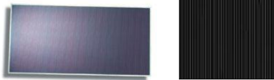
Εικόνα 1.4 Φωτοβολταϊκά κελιά: Αριστερα: τελουριούχο κάδμιο ( \text{CdTe} ), Δεξιά: Δισεληνοϊνδιούχος χαλκός ( \text{CuInSe}_2 )
