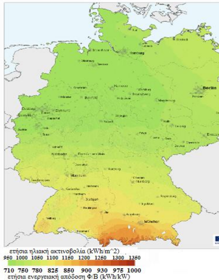
Εικόνα 3.2: Ηλιακή ακτινοβολία στη Γερμανία για συστήματα χωρίς κινητή βάση.[14]
