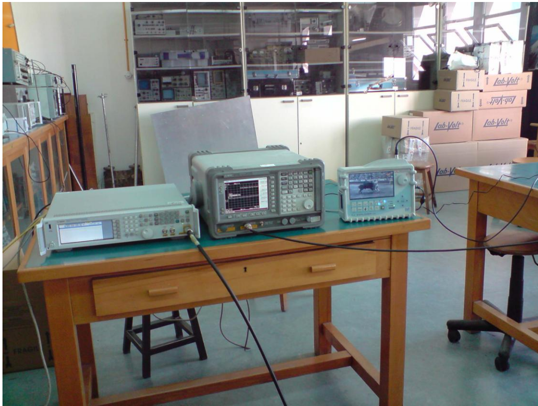
Εικόνα 5.2 Πάγκος με τα όργανα μετρήσεων
