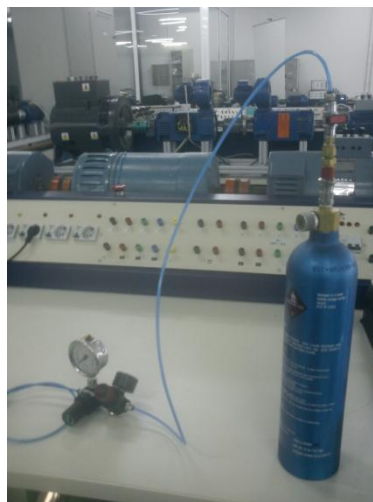
Σχήμα 6.1: Η φιάλη μεταλλικών υδριδίων στην οποία αποθηκεύεται το υδρογόνο και ο υποβιβαστής πίεσης.
