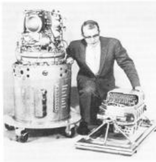
Σχήμα 2.3: Φωτογραφία του συστήματος κυψελών καυσίμου του Apollo μαζί με το σύστημα κυψέλης καυσίμου 1kW που χρησιμοποιήθηκε στην εξερεύνηση της σελήνης. [SCB+03]
