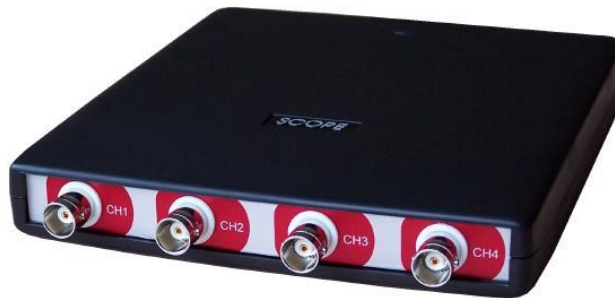
Σχήμα 6.5: Ψηφιακός παλμογράφος με τον οποίο έγινε καταγραφή της δυναμικής συμπεριφοράς.
