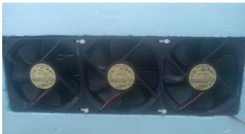
Σχήμα 6.3: Ανεμιστήρες για τη ψύξη και την τροφοδοσία του οξυγόνου.
