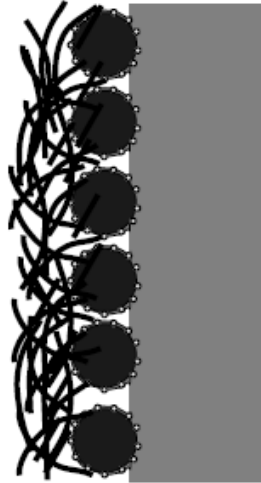
Σχήμα 3.6: Απλοποιημένη ιδανική δομή της ηλεκτροδίου PEM κυψέλης
