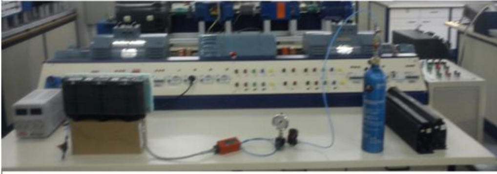
Σχήμα 6.4: Η συστοιχία κυψελών καυσίμου, η παροχή υδρογόνου και οι μεταβλητές αντιστάσεις που χρησιμοποιήθηκαν.
