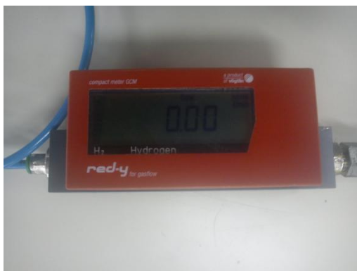
Σχήμα 6.2: Μετρητής ροής του υδρογόνου σε κανονικά λίτρα ανά λεπτό.
