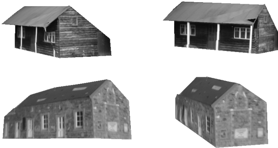
Σχήμα 6.7: Η 3Δ ανακατασκευή των κτηρίων όπως προέκυψε από την υλοποίηση του αλγορίθμου ανακατασκευής
