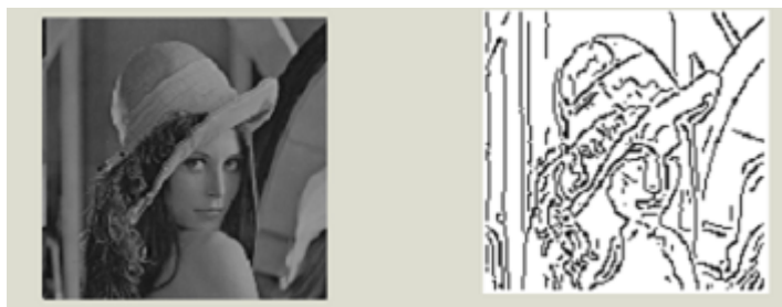
Σχήμα 4.1: Εφαρμογή του αλγορίθμου ανίχνευσης ακμών Canny στην αριστερή εικόνα. Το αποτέλεσμα φαίνεται στη δεξιά εικόνα.
