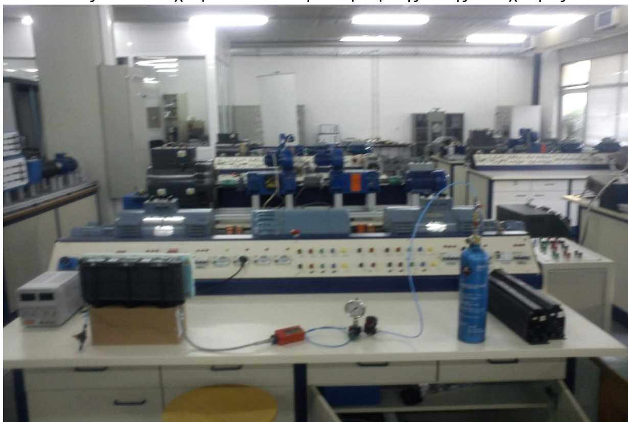
Σχήμα 5.1 Από αριστερά προς τα δεξιά διακρίνονται, η κυψέλη καυσίμου ο μετρητής ροής υδρογόνου, ο υποβιβαστής πίεσης, η φιάλη μεταλλικών υβριδίων και οι μεταβλητές αντιστάσεις.
