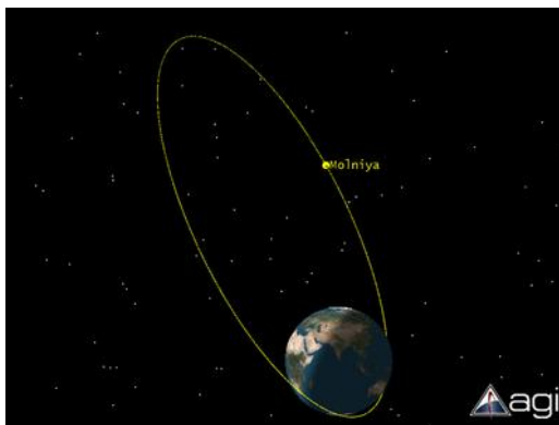
Σχήμα 1.1: Δορυφορική τροχιά HEO
