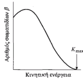
Σχήμα 2.4 Χαρακτηριστική καμπύλη διάσπασης \beta . Η μέγιστη κινητική ενέργεια που παρατηρείται για το σωματίδιο \beta αντιστοιχεί στην τιμή του Q της αντίδρασης.
