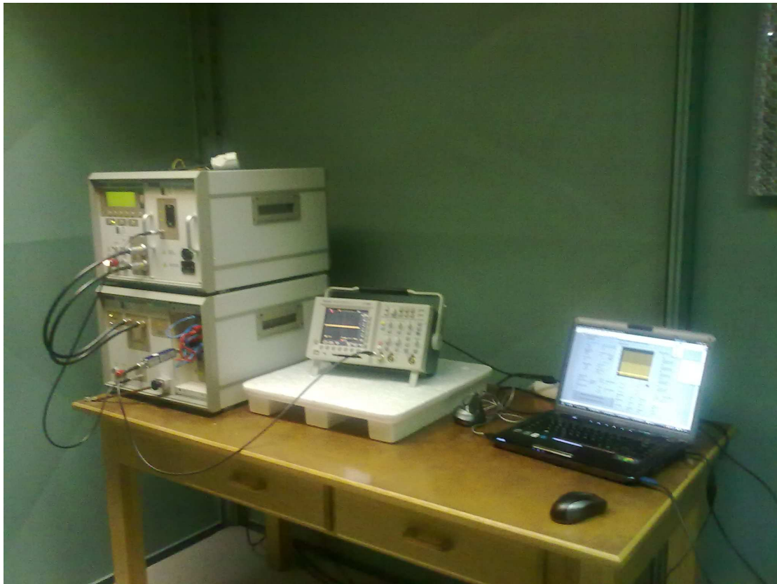
Φωτογραφία 1: Συνολική διάταξη που χρησιμοποιήθηκε για τη τέλεση των δοκιμών με τρόπο αυτοματοποιημένο, δηλαδή με έλεγχο μέσω Η/Υ.
