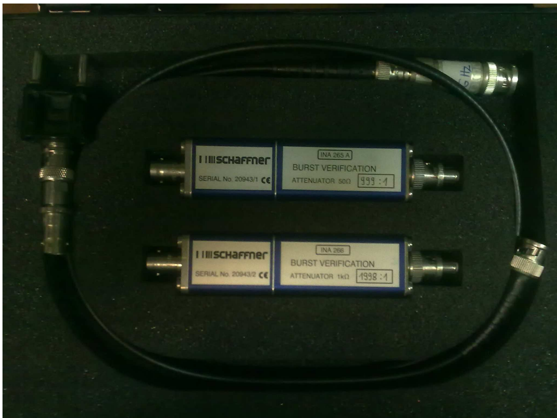
Φωτογραφία 5: Σετ βαθμονόμησης CAS 3025 (INA 265A και INA266) της SCHAFFNER.
