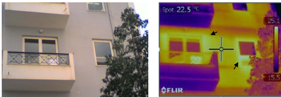
Εικόνα 2.13: Διαρροή αέρα γύρω από παράθυρο
