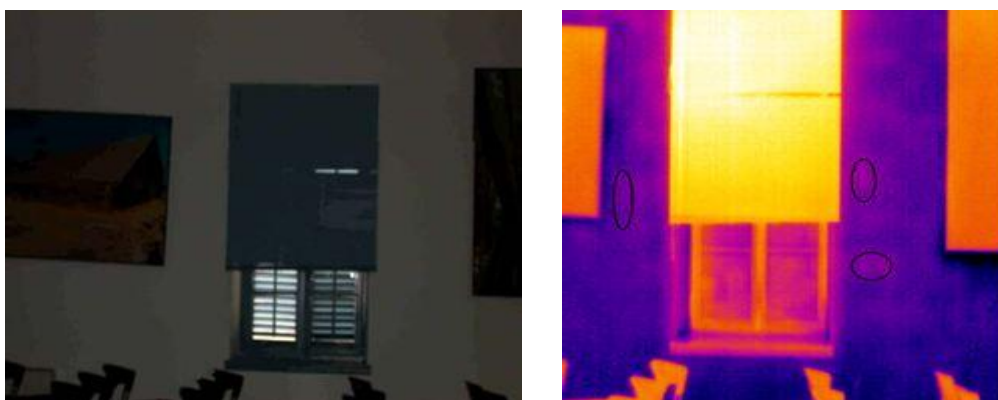
Εικόνα 2.34: Διαφορετικά υλικά σε ενιαία επιφάνεια – «Φαρμακείο» (ΤΠΠΑ)
