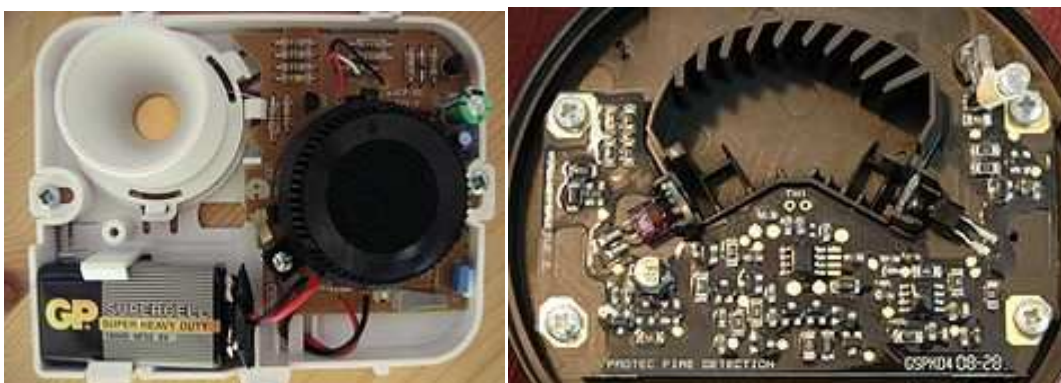
εικόνα 3.2 (α) εσωτερικό αισθητήρα ιονισμού, (β) εσωτερικό οπτικού αισθητήρα
