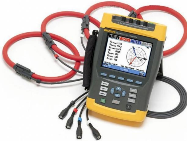
Εικόνα 5.2.42 Αναλυτής ηλεκτρικής ενέργειας
