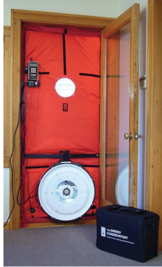
Εικόνα 3.1.1 Εγκατάσταση “blower door”
