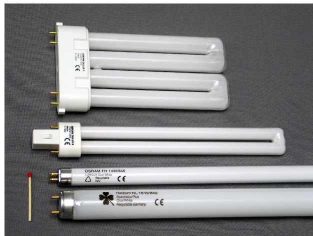
Σχήμα 6.2.5 Λαμπτήρες φθορισμού (α, β: συμπαγείς, γ: σωληνωτός T5, δ: σωληνωτός T8).
