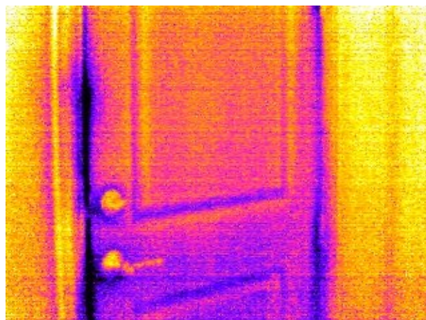
Εικόνα 3.3.6.14 Υπερβολική διείσδυση αέρα στην κορυφή της πόρτας
