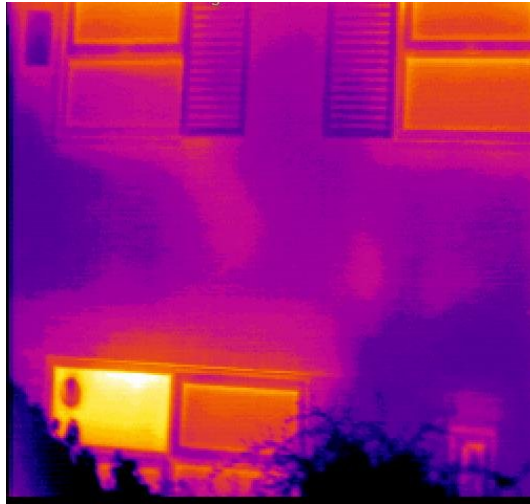
Εικόνα 3.3.7.30 Εξαιρετικά αυξημένη απώλεια θερμότητας από ένα από τα παράθυρα στο κάτω μέρος του σπιτιού όπου το παράθυρο είναι μονό, σε αντίθεση με τα υπόλοιπα που είναι διπλά.
