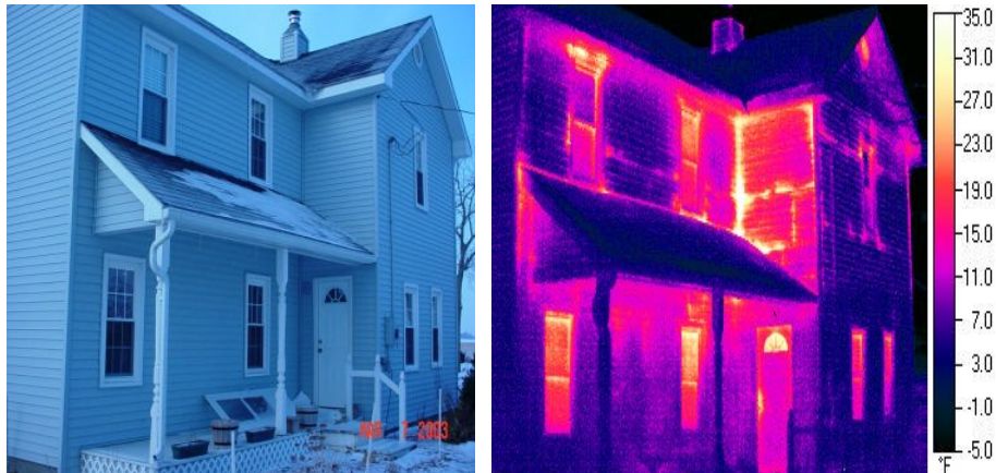
Εικόνα 3.3.7.23 Θερμικές απώλειες εξαιτίας έλλειψης μόνωσης και/ή υπερβολικής ροής αέρα
