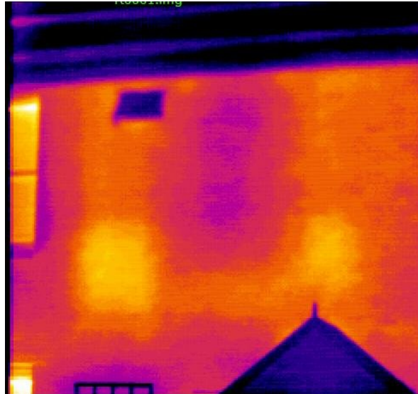
Εικόνα 3.3.7.28 Απώλεια θερμότητας από δύο θερμαντικά σώματα στον τελευταίο όροφο ενός σπιτιού. Τα ανακλαστικά πάνελ πίσω από κάθε θερμαντικό σώμα θα βοηθούσαν να συντηρηθεί η θερμότητα.
