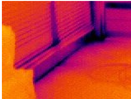
Εικόνα 3.3.5.8 Διείσδυση νερού από το περβάζι του παραθύρου.
