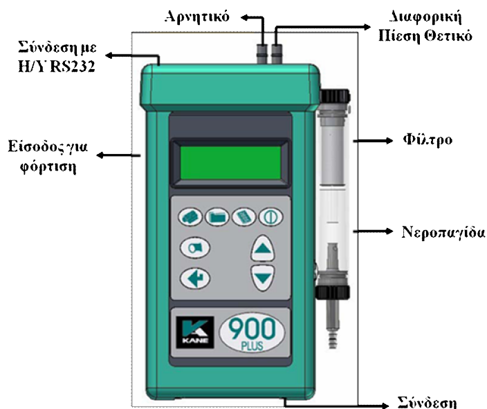
Σχήμα 5.2.2 Ηλεκτρονικός Αναλυτής Καυσαερίων KANE 900 PLUS
