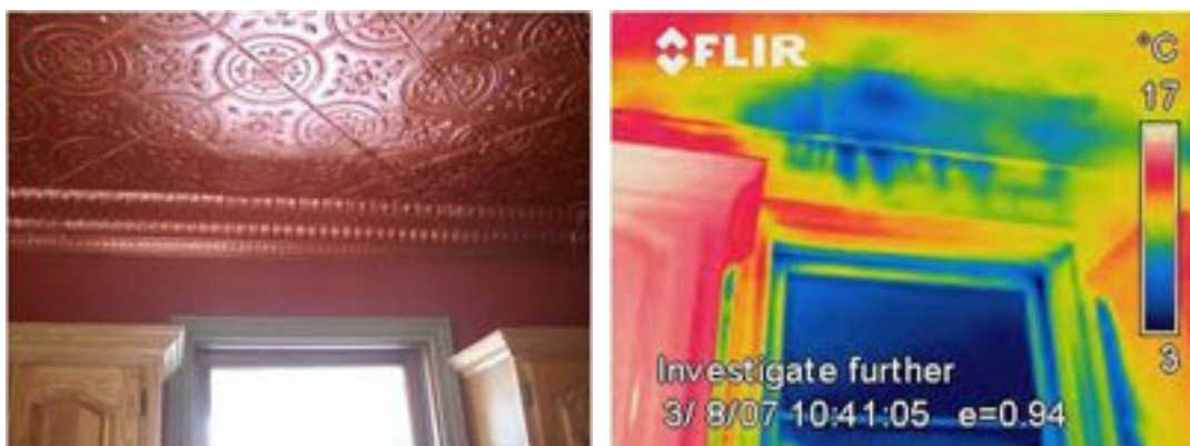
Εικόνα 3.3.6.12 Είσοδος κρύου αέρα μέσα από το φεγγίτη στο χώρο πίσω από την οροφή που είναι κατασκευασμένη από κασσίτερο.
