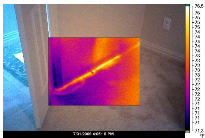
Εικόνα 3.3.5.19 Μεταφορά υγρασίας κάτω από το ντους στο χαλί του υπνοδωματίου.
