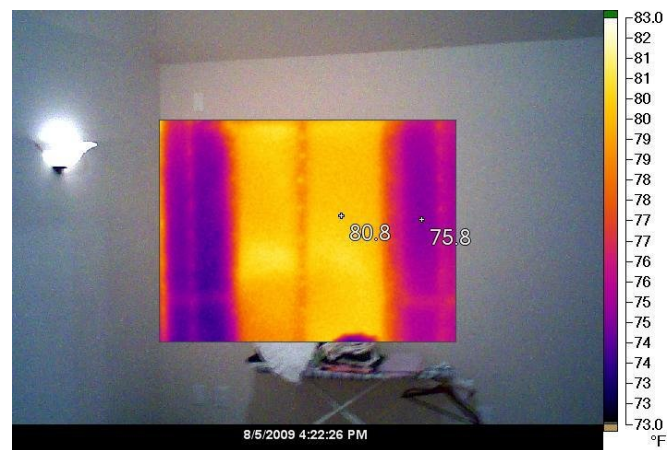
Εικόνα 3.3.2.16 Σε αντίθεση με την προηγούμενη περίπτωση εδώ φαίνεται ότι οι μη μονωμένες περιοχές εμφανίζονται στη θερμοκάμερα ως ανοιχτόχρωμες όταν ο καιρός είναι ζεστός.
