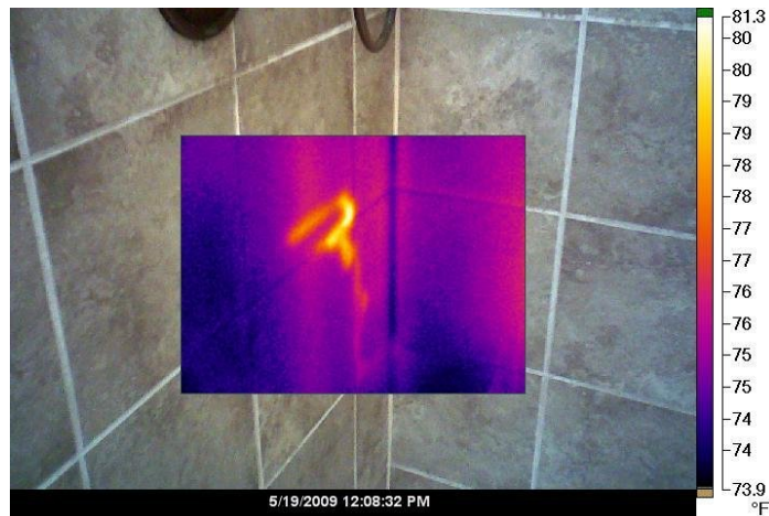
Εικόνα 3.3.4.2 Διαρροή σε σωλήνα πίσω από πλακάκι μπάνιου
