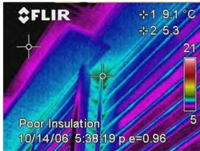
Εικόνα 3.3.7.9 Διαφυγή ζεστού αέρα από τη γωνία του σπιτιού.
