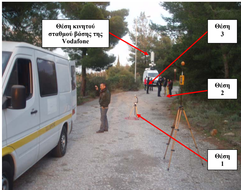
Εικόνα 5.2: Οι θέσεις λήψης μετρήσεων σε σχέση με την θέση του κινητού σταθμού βάσης της Vodafone για τα σενάρια μέτρησης 1 και 2
